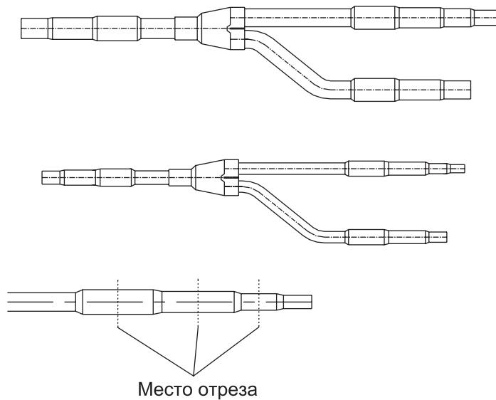
*Рис. 11.5 — Отрез разветвителя в нужном сечении*
