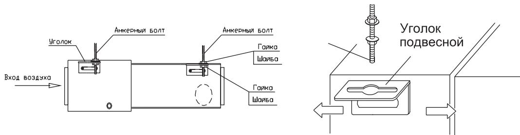
Рис. 10.26 — Установка блока
