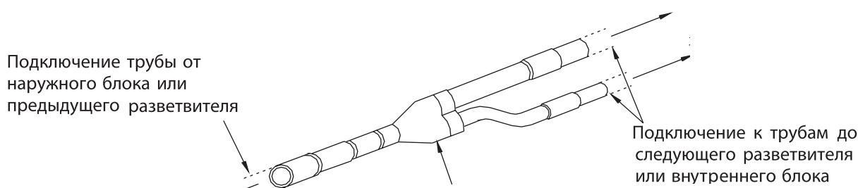
Рис. 11.4 — Подключение разветвителя
