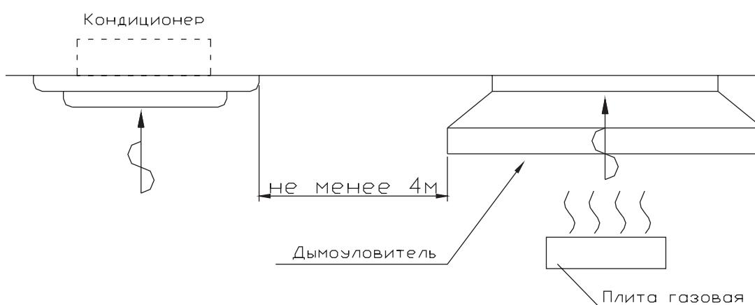
Рис. 10.16 — Требования по размещению кассетного блока
