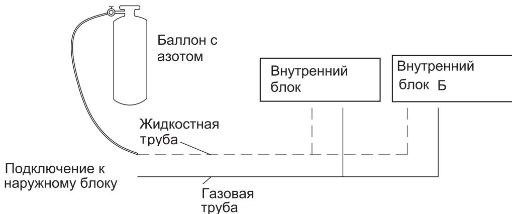
*Рис. 11.9 — Схема подключения для продувки трассы азотом*
