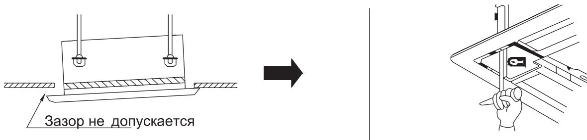
*Рис. 10.22 — Регулирование положения блока в горизонтальной плоскости*
