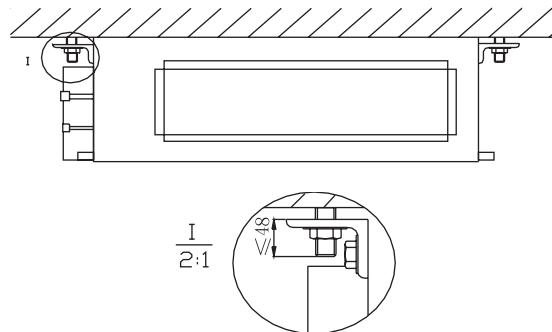
Рис. 10.27 — Крепление блока
