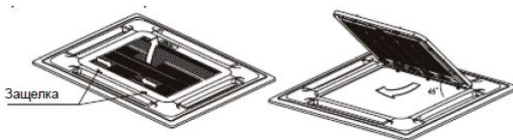
Б. Снимите монтажные крышки, расположенные с четырех углов декоративной панели. Открутите болты, ослабьте тросики крышек и снимите их.
