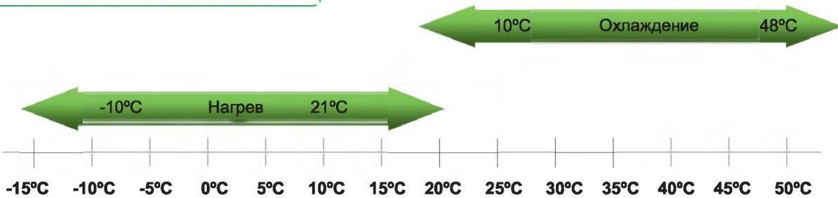
Температура воды на входе регулируется контроллером в соответствии с требованиями потребителя
